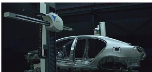
**焊装工艺：**主焊线和侧围线采用日本富士设备，主焊线采用 ABB 机器人焊接。白车身检测采用了美国海克斯康双悬臂三坐标。优秀毕业生可向机器人维修工程师、焊接工艺工程师等高级岗位晋升。
