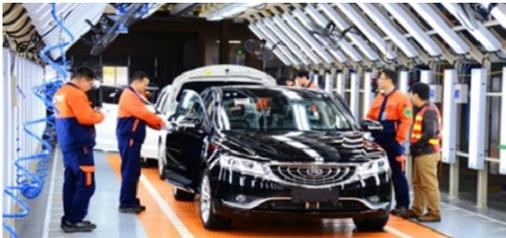
**总装工艺**：使用世界先进的德国杜尔检测线以及杜尔制动液加注机，发动机装配采用 AGV 小车、ABB 机器人自动打胶设备。优秀毕业生可以向汽车零部件质量检测、零部件设计变更、装配工艺工程师等方
