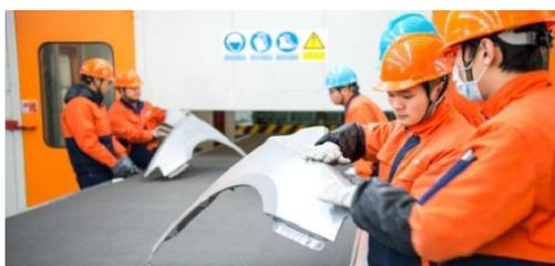
**冲压工艺：**是汽车生产过程中精度要求最高，员工技能要求也相对较高的工厂；自动化线采用了 ABB 机器人，德国 SMT 清洗机以及 ABB 公司集成的自动化连线。接收实习生主要从事线首上料、线尾检查工作。
